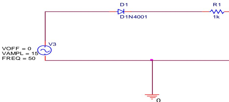
Déterminer l'évolution des tensions aux bornes du générateur, de la charge et de la diode.
