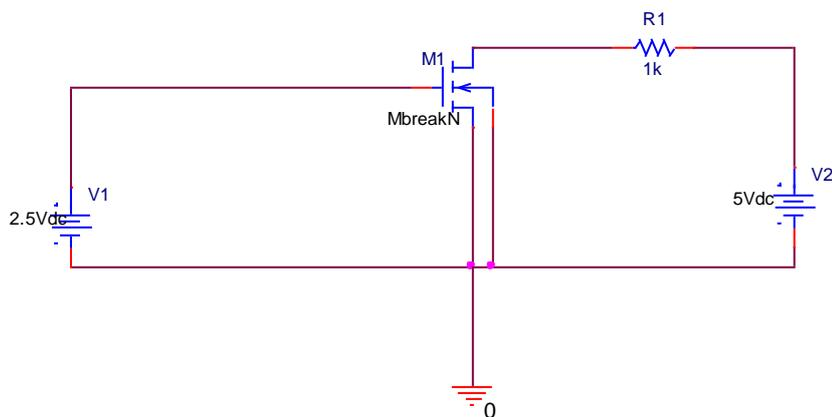
a)  $V_1$  est une alimentation continue variable entre 0 et 8 V;  $V_2 = 5V$
